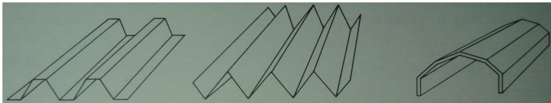
Figura 20 - Exemplos de cascas formadas por placas dobradas. (Fonte: Billington, 1982 - Pág.21).
