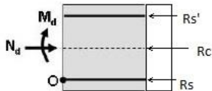
Figura 65 - Esquema de flexo-compressão para seção de concreto armado.
