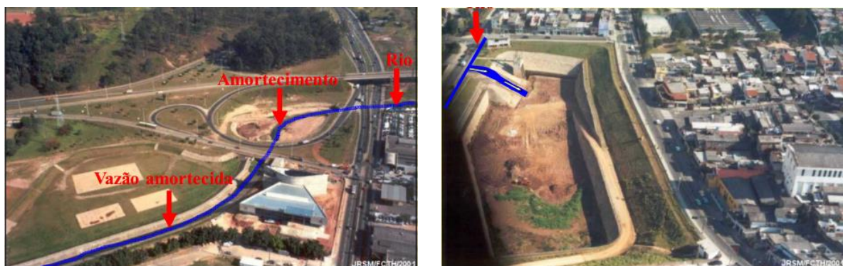
Figura 13 - À esquerda, exemplo de reservatório online e o respectivo escoamento da água; À direita, reservatório offline. (Fonte: Notas de aula PHA2537 – EP).
