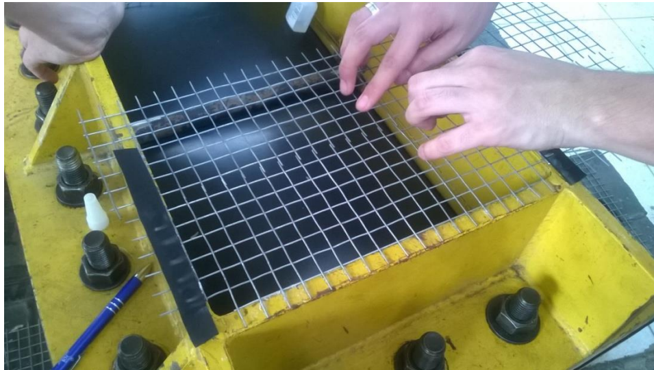
Figura 48 - Fixação da tela metálica na borda caixa.
