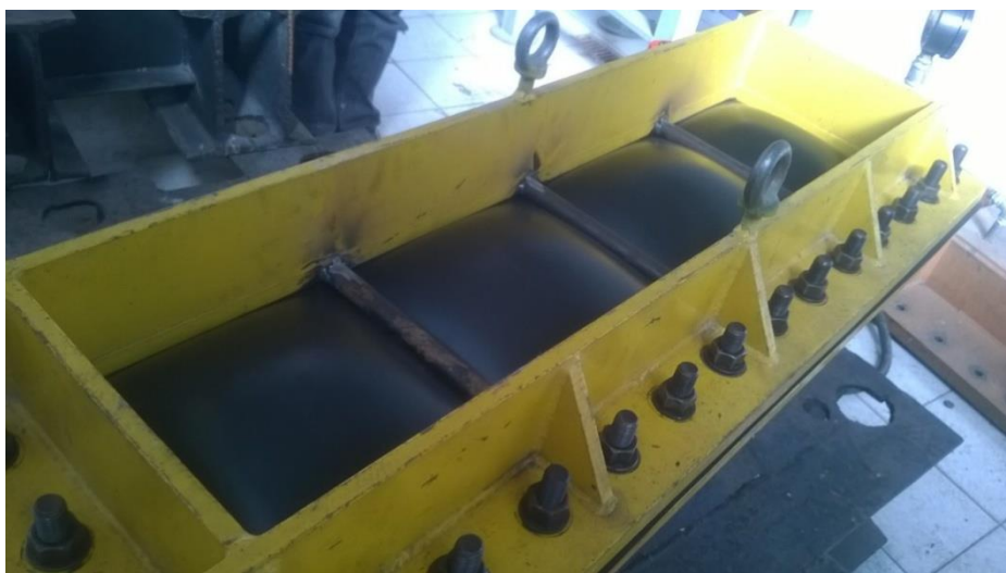
Figura 46 – Caixa metálica com membrana pneumática sob pressão hidrostática.
