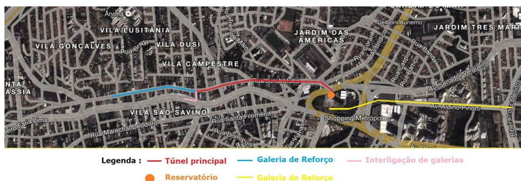
Figura 30 - Esquema com componentes das obras. (Fonte: Base para esquema retirada do Google Maps).
